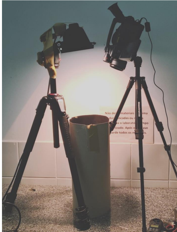
Figura 3 – Setup dos experimentos envolvendo o aquecimento de abelhas mortas. Abelhas mortas alfinetadas foram colocadas dentro de um cilindro de cartolina (centro da imagem). As abelhas tinham uma distância de 45 cm de uma fonte luz (lado esquerdo da imagem). Uma termo-câmera (lado direito da imagem) foi programada para tirar fotos a cada 30 segundos.
