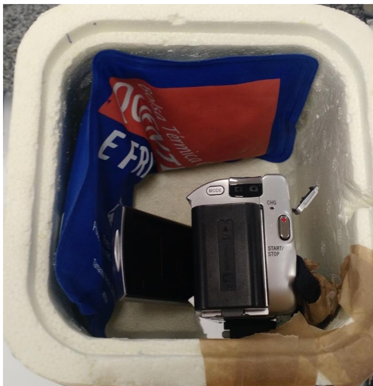
Figura 2 – Setup utilizado para impedir o superaquecimento da filmadora dentro da estufa. A câmera foi envolta por um isopor com abertura para realizar as filmagens e dentro do isopor foi colocada uma bolsa térmica previamente congelada.
