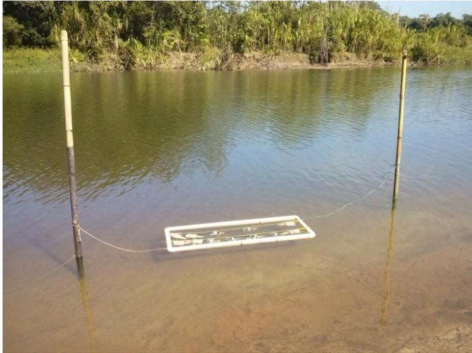
Figura 6. Incubação da macrófita aquática *Egeria densa* em frascos claros e escuros expostos a radiação solar durante uma hora.
