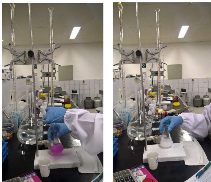
Figura 5. Quantificação do \text{CO}_2 através da solução de NaOH 0,5 M e sua quantificação por titulação com HCl.
