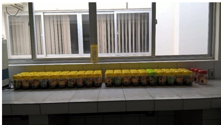
Figura 4. Distribuição de 60 unidades amostrais (frascos com solo) e 3 frascos sem solo, todos com 20 mL de NaOH 0,5 M em vidros hermeticamente fechados.
