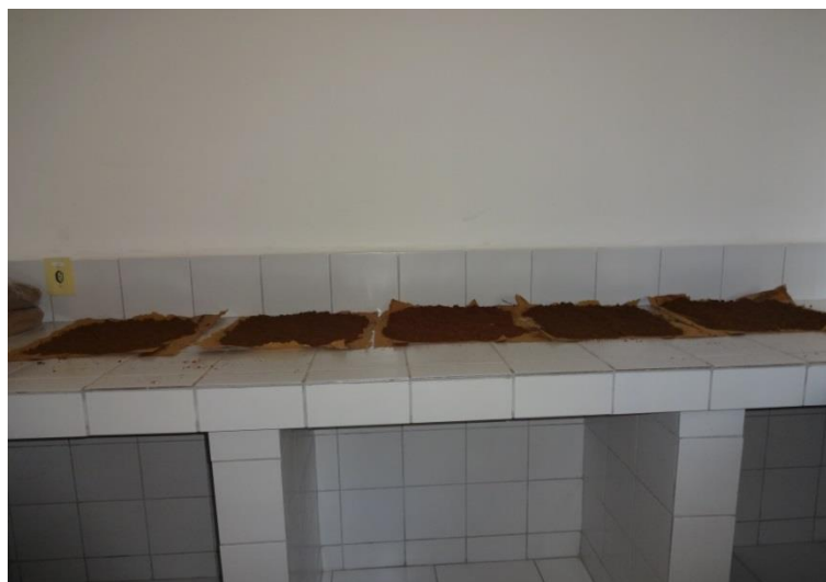
Figura 2. Secagem do solo após salinização com diferentes CE (condutividade elétrica).
